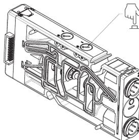
Accionamiento manual, versión P: actuación sin dispositivo empujar y girar (solo presionar)
