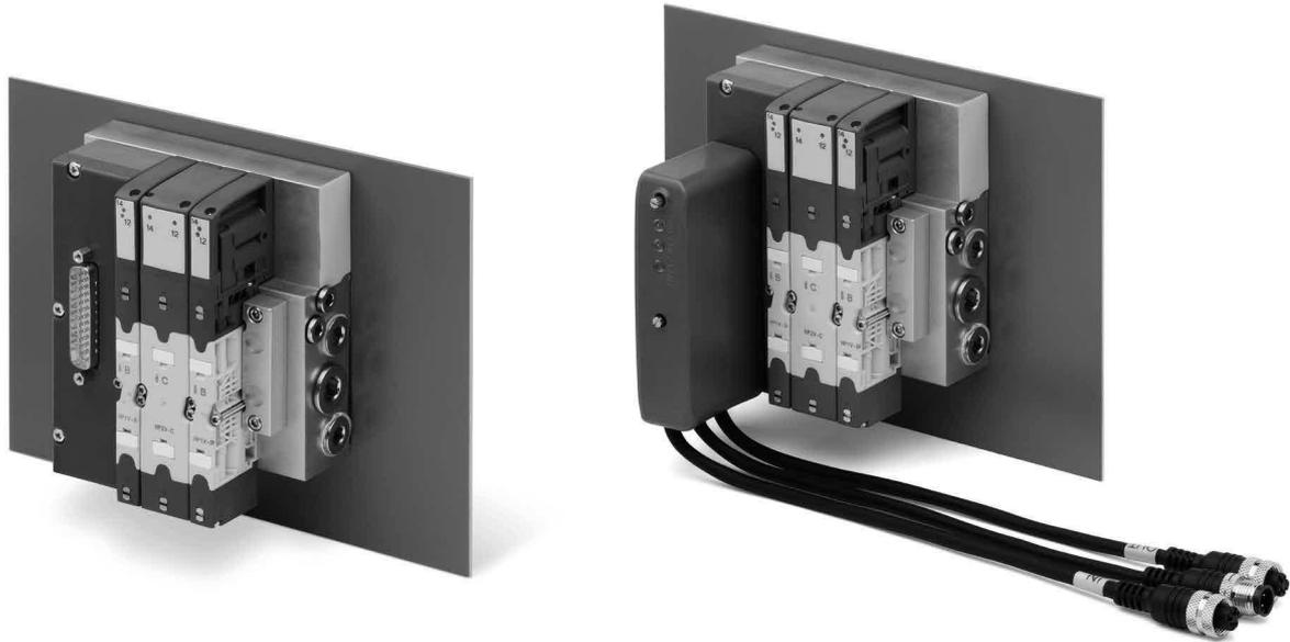
La versión multipolar se puede conectar de forma rápida y segura gracias a la conexión eléctrica por medio de una conexión de cable con 25 o 37 pins con conexión en línea o angular. Es posible crear zonas con fuente de alimentación diferenciada y con presión separada / escape. Gracias a las sub-bases con tablero monostable, se pueden realizar islas hasta un máximo de 24 bobinas en 20 pos. válvula con la conexión de 25 pin y 32 bobinas en 28 pos. válvula con la conexión de 37 pins.
