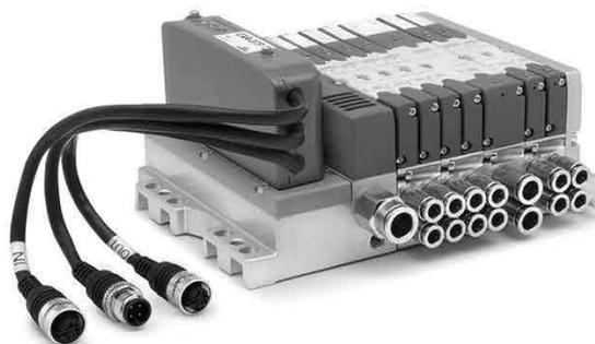
La versión multipolar se puede conectar de forma rápida y segura gracias a la conexión eléctrica por medio de una conexión de cable con 25 o 37 pins con conexión en línea o angular. Es posible crear zonas con fuente de alimentación diferenciada y con presión separada / escape. Gracias a las sub-bases con tablero monostable, se pueden realizar islas hasta un máximo de 24 bobinas en 20 pos. válvula con la conexión de 25 pin y 32 bobinas en 28 pos. válvula con la conexión de 37 pins.
