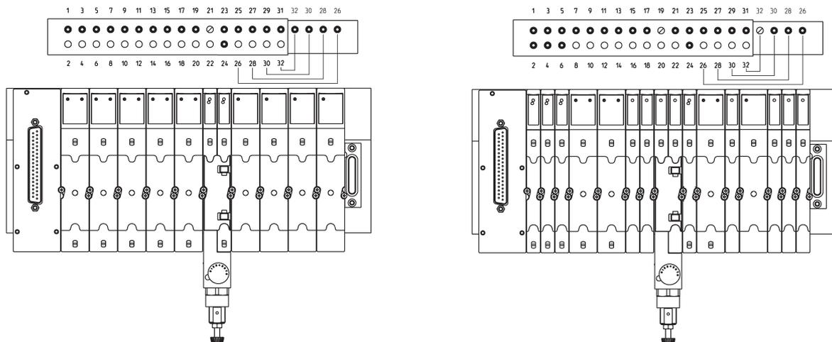
La válvula de tamaño 2 no necesita comandos con números pares (de pines) colocados en la parte inferior del tablero. Estos pueden ser utilizados en la tarjeta de expansión, permitiendo así la realización de islas de válvulas constituidas por hasta 16 válvulas.
