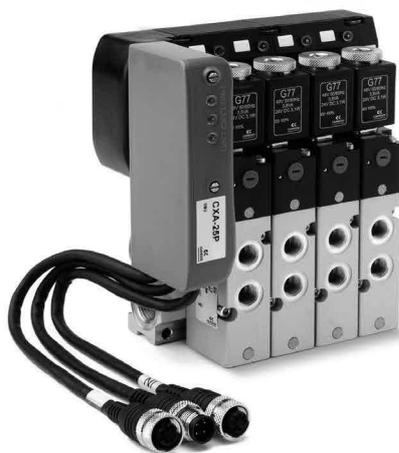
En la versión Multipolar la posición frontal del conector Sub-D de 25 pins hace la conexión más fácil. Los conectores con cable pre alambrado, que están disponibles en diferentes longitudes con orientación radial o axial, simplifican la conexión eléctrica. La isla puede ser configurada hasta un máximo de 22 bobinas, usando módulos eléctricos monoestables y biestables en 22 posiciones de válvulas, por ejemplo 22 electroválvulas monoestables.
