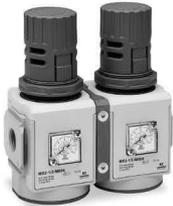
La imagen del lado izquierdo muestra que, con la utilización de los kits de montaje adecuados con o sin terminales, es posible montar un cierto número de reguladores manteniendo una única presión de entrada. La regulación de la presión en salida (conexión OUT) de cada regulador puede ser establecida girando el elemento de maniobra en sentido horario o antihorario y bloqueándolo hasta obtener la presión deseada. Esta regulación no afecta al regulador de presión anterior o posterior.
