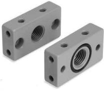
El kit MC104-FL incluye: 1 brida izquierda; 1 brida derecha; 4 tornillos M4x14; 2 O-ring 2068.
