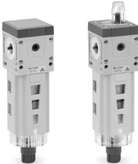
Este filtro fino de separador de aceite remueve los sólidos con dimensiones desde 0.1 hasta 5 µm y vapores de aceite con una concentración desde 0.01 hasta 0.1 mg/m³. Para un correcto funcionamiento ellos requieren un pre-filtro. Dadas las características de este filtro, es recomendable reemplazar el elemento filtrante al menos cada 12 meses o 8000 horas de trabajo.
