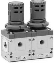
Con la versión Manifold es posible unir una batería de reguladores los cuales son alimentados por una única fuente de entrada de presión. Cada regulador puede ser ajustado a cualquier presión (menor que la presión de entrada). La conexión frontal o posterior de cada regulador permite derivar aire al valor de presión ajustado en ese regulador.
