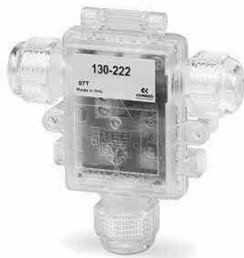
El dispositivo de control electrónico Serie 130 permite pilotar cualquier válvula proporcional con un máximo de corriente de 1 A. Convierte una señal de entrada estándar (0-10V o 4-20 mA) en una señal PWM para obtener a la salida de la bobina una corriente proporcional a la señal de entrada.
