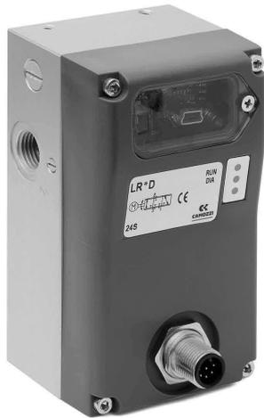
Las electroválvulas proporcionales digitales Series LR son de 3/3 vías, directamente accionadas con un sistema de corredera giratoria patentada, con un circuito de control de bucle cerrado. La tarjeta electrónica está integrada dentro del cuerpo de la válvula lista para ser conectada.
