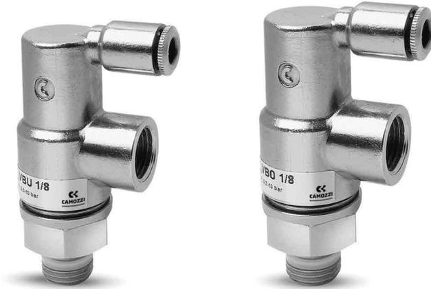
Estas válvulas de bloqueo unidireccional y bidireccional fueron diseñadas para poder montarse directamente en los puertos de los cilindros. Pueden ser usadas como válvulas de alto caudal para soplar, limpiar piezas, llenado de volúmenes. Para estas aplicaciones se requiere conectar la alimentación al puerto 2 (lado de la rosca macho).
