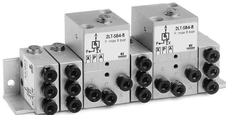
Las funciones lógicas de base de la serie "2L" han sido realizadas en 5 modelos diferentes y se pueden instalar separadamente gracias a los dos orificios pasantes en el cuerpo. La escuadra 2LQ - 8A permite el montaje en batería, ubicando las entradas y salidas frontalmente, facilitando el montaje de los tubos de conexión.
